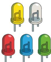
Los diodos leds son componentes capaces de emitir luz cuando una corriente eléctrica circula a través de ellos. Es recomendable limitar el valor de esta corriente mediante el uso de una resistencia y evitar de esta forma que se quemé el componente.
